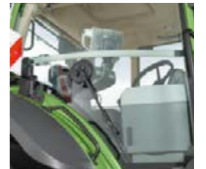
L'essuie-glace latéral à 220° assure une visibilité optimale du côté droit, même dans les conditions les plus difficiles.
