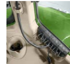
Le passe-câble intégré assure un guidage propre des câbles, lunette arrière fermée tout en assurant la protection contre la poussière, l'eau et le bruit. Plus de câbles qui s'emmêlent : tous les câbles sont fixés et guidés dans le montant arrière.
