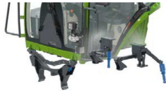
La suspension de cabine mécanique est dotée de deux plots coniques, et l'arrière de deux ensembles ressorts mécaniques.
