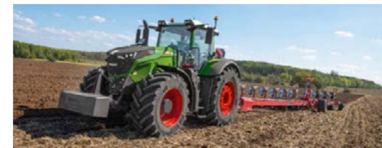
Grâce au système de gestion de tracteur (TMS) et au superviseur de sous-régime 2.0, le tracteur règle le régime moteur optimal en fonction de la vitesse d'avancement.
