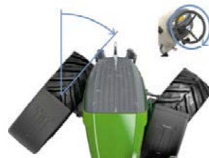
Avec VarioActive, vous pouvez arriver en butée de braquage d'un seul tour de volant.
