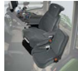
Le siège super confort Evolution dynamique dispose d'une suspension pneumatique alimentée par le compresseur du tracteur, d'une commande de climatisation active et d'un appui-tête.
