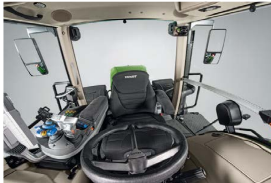
Pour l'utilisation en poste de conduite inversé, il suffit de faire pivoter la plateforme opérateur de 180°. Vous pouvez ensuite utiliser toutes vos commandes en marche arrière, exactement comme vous le feriez en marche avant. Même le passager n'a pas à sacrifier son confort d'assise en marche arrière.
