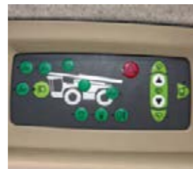
■ Interrupteur simple ou partagé pour les feux de travail et lave-glace avant.
