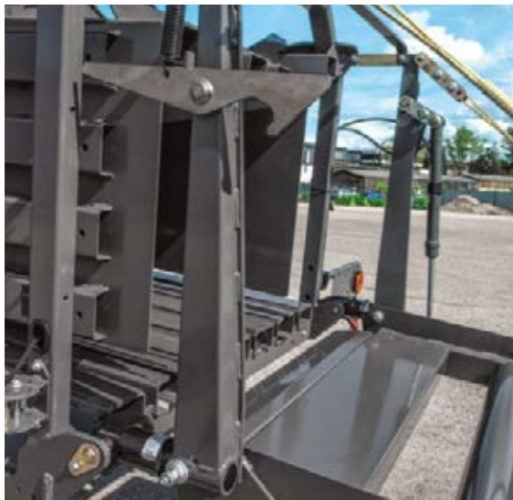
■ Les cellules de charge des balles entre le canal de compression et l'expulseur de balles mesurent le poids exact de la balle, en transférant en même temps les données vers votre terminal. Le système de câblage étant intégré au châssis, les câbles sont donc protégés de tout arrachement.
