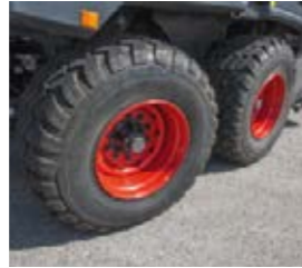
■ L'essieu tandem suiveur garantit une large surface de contact doublée d'une excellente maniabilité.
