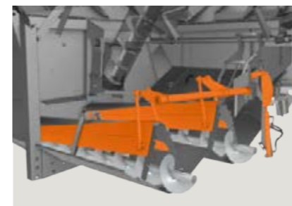
Les clapets recouvrant les vis du plancher de la trémie à grain contrôlent la vitesse de vidange dans cinq positions.
