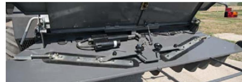
Le diffuseur du broyeur à commande électrique (option) permet d'adapter la répartition en conditions venteuses.
