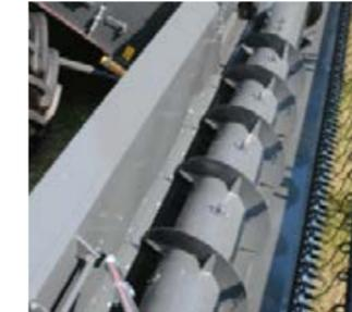
Le rouleau PowerFeeder assure un transfert parfait des récoltes entre la barre de coupe et le convoyeur.
