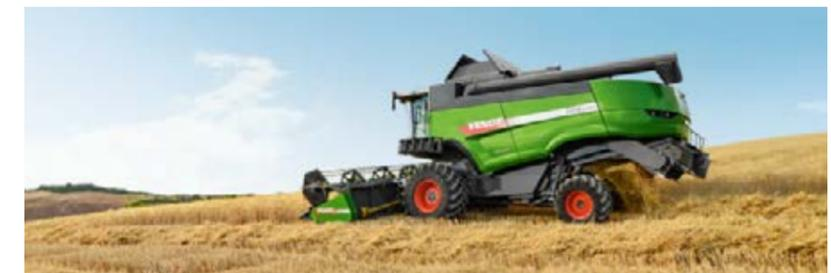
Pour minimiser l'usure provoquée par les impuretés qui s'infiltrent dans la machine, nous utilisons des matériaux très résistants à l'usure sur notre version de moissonneuse-batteuse spéciale riz, en particulier au niveau des composants qui sont en contact direct avec la récolte.
