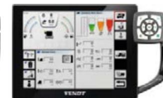
Le menu principal indique les données réelles et prédéfinies, notamment la hauteur de coupe, la perte de grains des secoueurs et des grilles ainsi que la quantité d'otons. Les paramètres du régime du batteur, l'ouverture du contre-batteur, le régime du ventilateur et l'ouverture des grilles se trouvent juste en dessous. Les touches de raccourci sur l'écran permettent de régler rapidement tous les paramètres.
