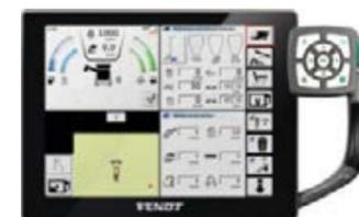
L'écran dans l'angle supérieur gauche indique des informations comme le régime moteur et la vitesse d'avancement. Les niveaux de carburant, d'AdBlue, d'huile et la température du moteur sont également affichés. Ce graphique montre aussi l'état actuel du niveau de grain en trémie et de la goulotte de vidange de la moissonneuse-batteuse.
