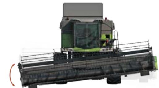
Le contrôle automatique de la coupe AutoLevel de série assure une hauteur de coupe constante sur toute la largeur.
