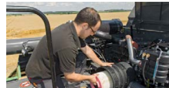
Nettoyage du filtre à air
