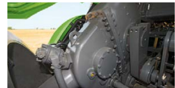
Un boîtier haute capacité équipe la presse XD. En tout, le boîtier XD est 35 % plus lourd que le modèle standard. Il peut donc générer encore plus de pression de compression.
