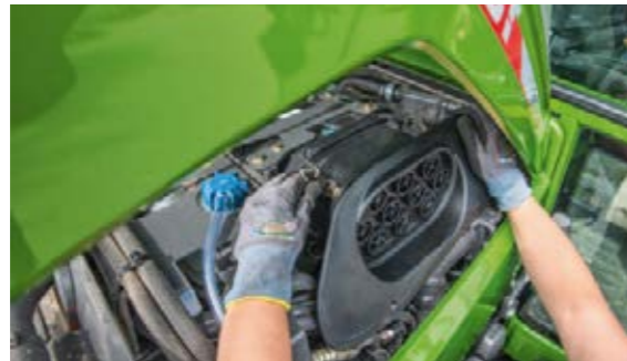
Le filtre à air à préfiltration cyclonique maximise le débit d'air et la durée de vie du filtre. Il est compact, léger et particulièrement étanche. Avantage : maintenance réduite.
