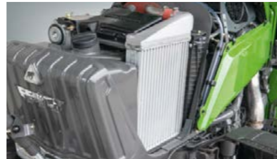
Le système de refroidissement possède de larges ouvertures d'admission pour optimiser l'alimentation en air. Avantage : contamination faible dans des conditions extrêmes. Le refroidisseur d'huile de la transmission refroidit l'huile hydraulique à l'aide d'un échangeur de chaleur.
