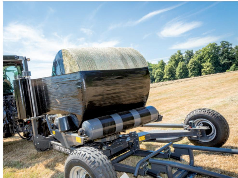
Sur la MF TW 130, la roue de transport située à droite peut tourner autour d'un axe pour accroître la largeur totale de 2,30 à 2,85 m et améliorer la stabilité de l'enrubanneuse pour le travail.
