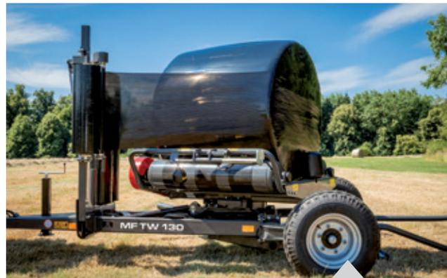
Le bon chevauchement du film est garanti par le rapport entre la vitesse de rotation de la balle et la vitesse de la table d'enrubannage. Les guides sur la table d'enrubannage permettent de maintenir la balle bien en place au centre.
