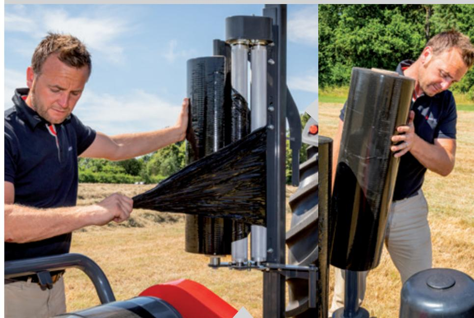
L'utilisateur peut aisément adapter le nombre de couches de film requis en fonction de la culture et des conditions. Le dispositif de pré-étirage conçu pour des rouleaux de 500 ou 750 mm et qui peut être réglé à 55 ou 70 % d'étirage permet un enrubannage plus serré et réduit la consommation de film. Un système de verrouillage rapide permet de remplacer rapidement et facilement les rouleaux vides. Les espaces de stockage permettent de transporter jusqu'à 3 rouleaux de film supplémentaires.
