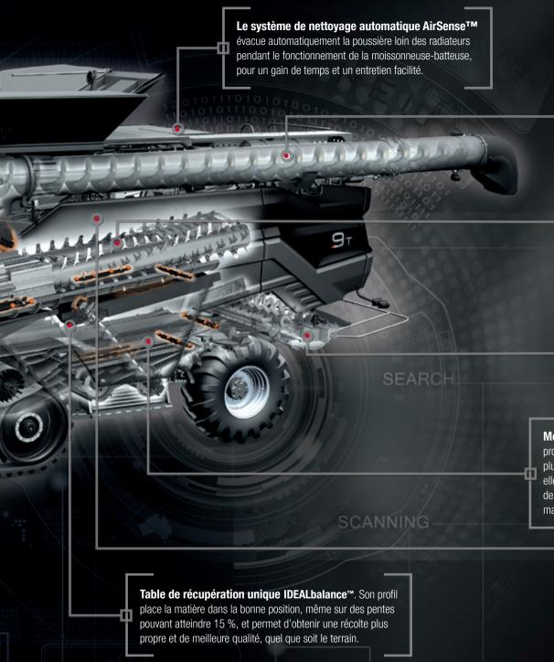
Le débit de vidange le plus rapide du marché. Le système Streamer 210, d'une capacité de 210 l/s, est 32 %\* plus rapide que le plus proche concurrent. Il accélère la vidange du grain tout en maintenant la qualité de la récolte. Des trappes hydrauliques permettent à l'utilisateur de faire varier le débit de vidange. Différentes longueurs de vis sont disponibles en option.
