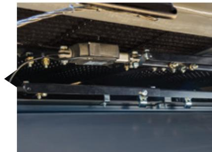
Le contrôle électronique des grilles à partir de la cabine permet de surveiller facilement la propreté du grain. Les divisions hautes des grilles améliorent le rendement sur les terrains accidentés.
