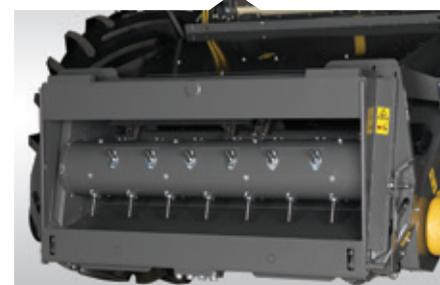
Le rouleau d'alimentation, situé à l'avant du convoyeur, offre un débit de récolte régulier, de la table de coupe jusque dans le convoyeur. Le système d'alimentation peut s'inverser en toute simplicité à partir de la cabine.
