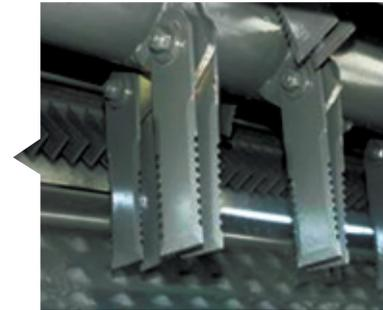
Une plaque bosselée réglable, montée de série, assure un broyage de paille homogène.
