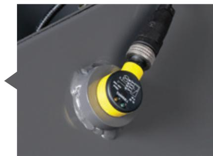
Un capteur indique le volume de retour d'ôtions directement sur le terminal en cabine, ce qui permet de rectifier rapidement les réglages de la machine afin d'améliorer les performances.
