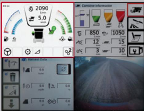
L'**écran d'Informations générales** est constamment affiché dans le coin supérieur gauche du terminal. Le régime moteur et la vitesse d'avancement sont affichés à côté des jauges de carburant, d'AdBlue, d'huile et de température moteur. Un graphique affiche également le statut en temps réel de la trémie et de la goulotte.
